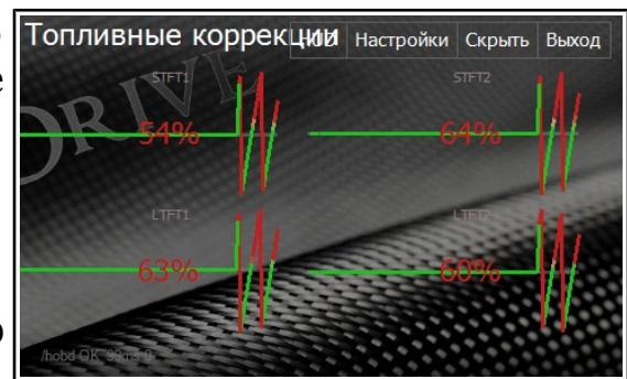
Топливные коррекции в пределах нескольких процентов означают нормальную работу двигателя.
